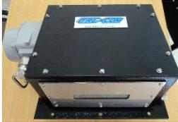
A Válvula de Alívio Motor é um componente utilizado como dispositivo de segurança para evitar a condição de sobrepressão máxima de grandes invólucros e máquinas girantes, além de integrar a válvula de purga, com um conjunto de placas de orifício (2.000, 3.000, 4.000, 5.000 e 6.000 Nl/min) que deve ser substituída conforme volume do invólucro a ser pressurizado. O Set Point de atuação desta válvula é ajustável manualmente de forma simples conforme a aplicação.
