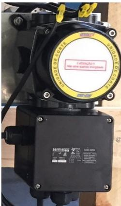
Este componente é utilizado para realizar o corte automático de alimentação elétrica no interior do invólucro pressurizado e deve ser utilizado quando o equipamento está instalado em Zona 1 ou 21, EPL Gb ou Db.
