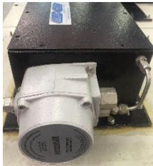
Sensor de Fluxo utilizado para instalações em Zona 1, EPL Gb é instalado na válvula de alívio (V-RV-1) e garante que o fluxo de saída do gás de proteção do invólucro durante o processo de purga esteja conforme a especificação.
