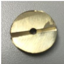
Este componente juntamente com a válvula solenoide faz parte do circuito de entrada do gás de proteção no invólucro pressurizado.
